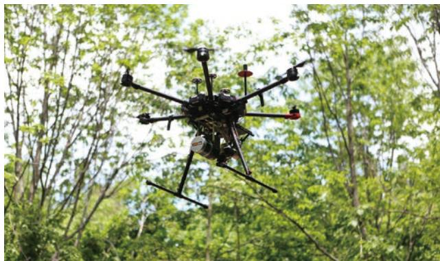
ドローンによる森林のレーザーセンシングの様子(長野県下高井郡山ノ内町にて)
